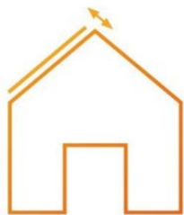
Écartement max. de 20 cm par rapport au pan de toit
